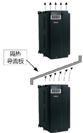
图2-1 FU9000D变频器各功率等级安装空间要求
