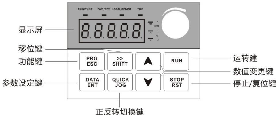
图3-1 操作面板示意图
