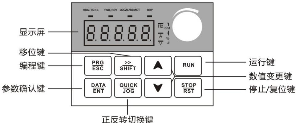
图3-1 操作面板示意图
