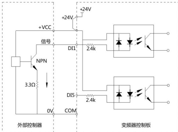
图2-6 漏型接线方式
