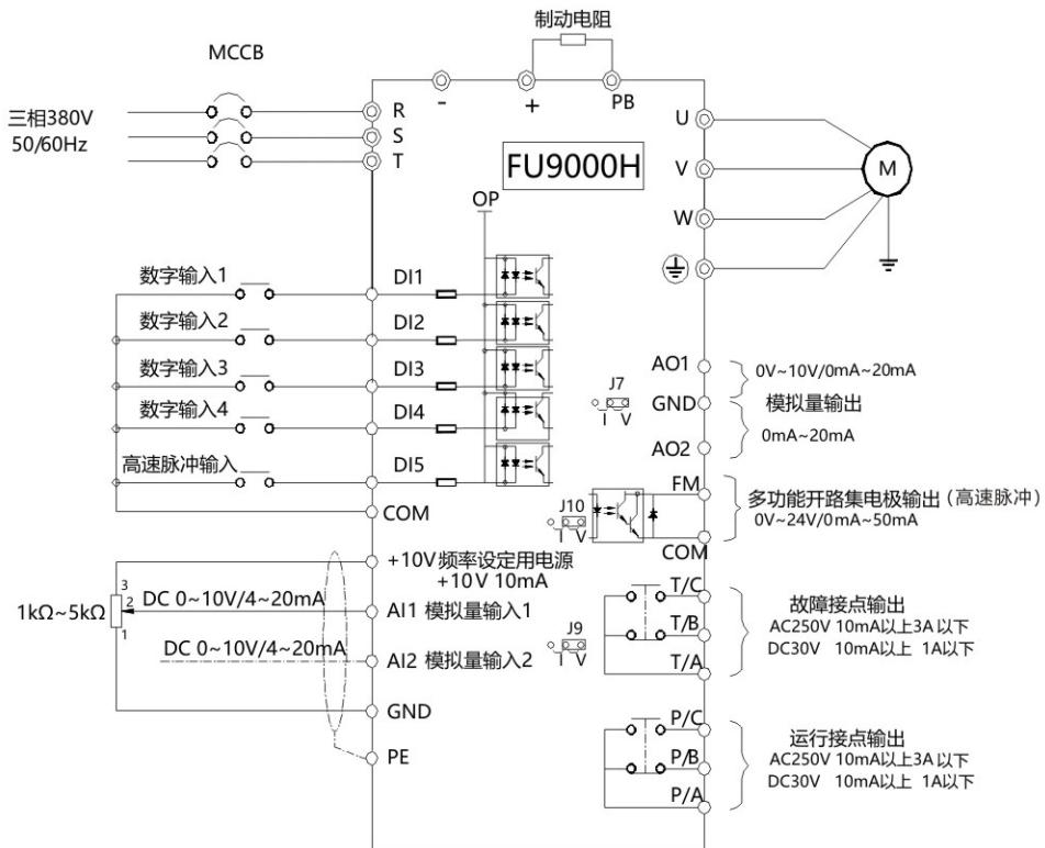
图2-4 变频器控制回路接线方式
