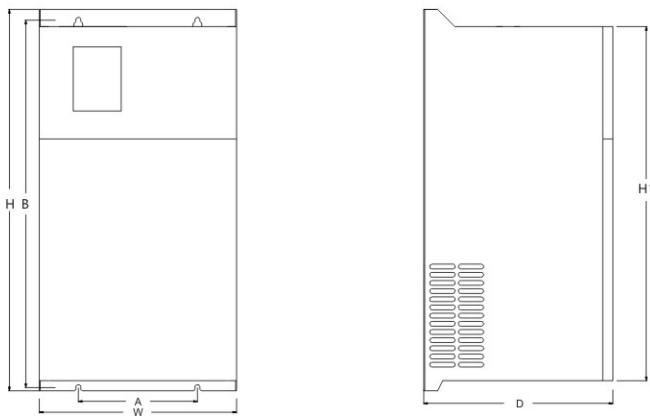
图5-2 FU9000H系列 钣金结构外型尺寸及安装尺寸示意图
