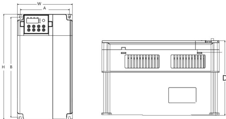
图5-1 FU9000H系列 塑胶结构外型尺寸及安装尺寸示意图
