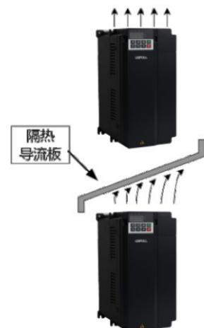
图2-1 FU9000H变频器各功率等级安装空间要求
