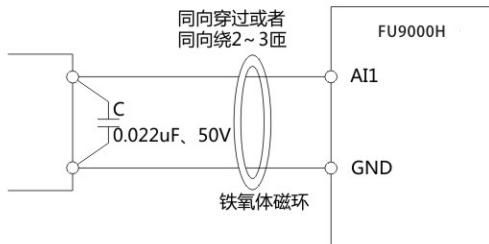
图2-5 模拟量输入端子处理接线图
