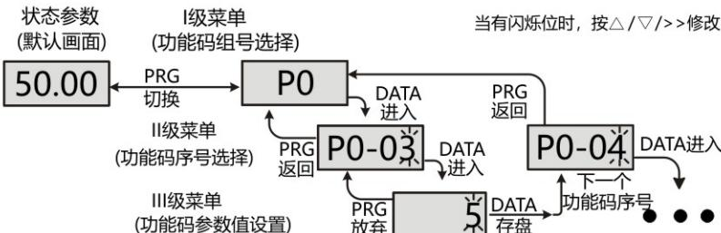
图3-2 三级菜单操作流程图
