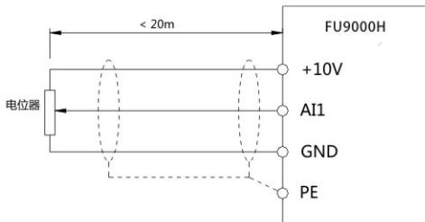
图2-6 模拟量输入端子接线示意图
