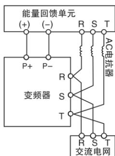
图 4-21 能量回馈单元连接图
