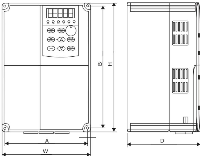
图 A-4.7.5kW 及以下机型外形尺寸（220V）
