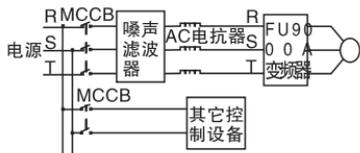
图4-19 主回路电源侧连接图
