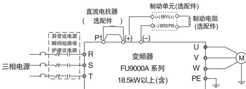
图4-14 18.5kW以上(含)主回路接线图
