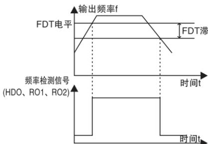
图6-18 FDT电平示意图
