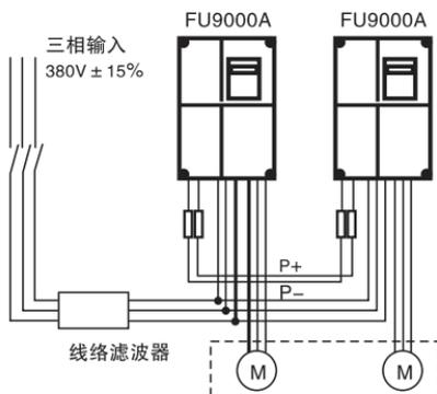
图 4-22 共直流母线的连接
