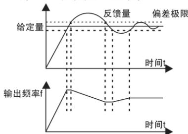
图 6-23 偏差极限与输出频率的对应关系
