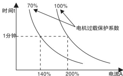
图 6-27 电机过载保护系数设定
