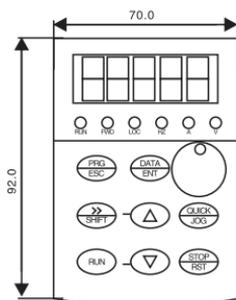
图 A-9 外引键盘的安装尺寸
