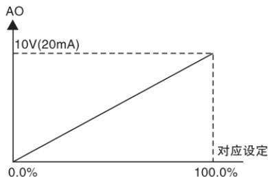
图6-14 给定量与模拟量输出的对应关系
