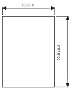
图 A-10 外引键盘 (小) 的开孔尺寸
