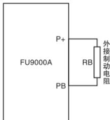
图 B-1 制动电阻的安装
