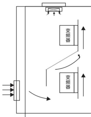
图 A-8 多台变频器的安装
