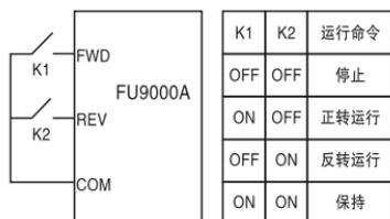
图6-9 两线式控制(使能与方向合一)
