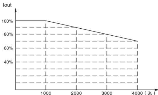
图3-1 安装地点的海拔高度与变频器降额曲线
