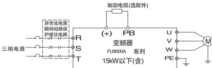
图4-13 15kW以下(含)主回路接线图
