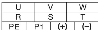
图4-7 主回路接线端子图 (350~500KW)
