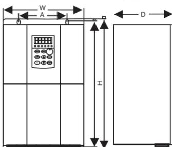
图A-2 18.5~110kw及以下机型
