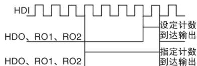
图6-17 设定计数值和指定计数值示意图
