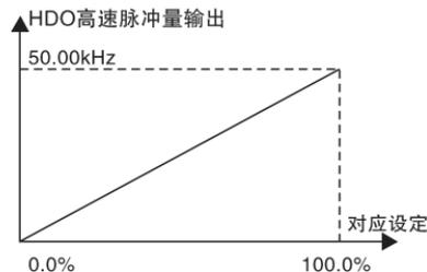
图6-15 给定量与高速脉冲输出的对应关系
