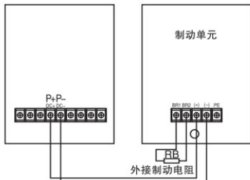
图 B-2 制动单元的连接
