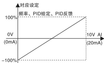
图6-13 模拟给定与设定量的对应关系
